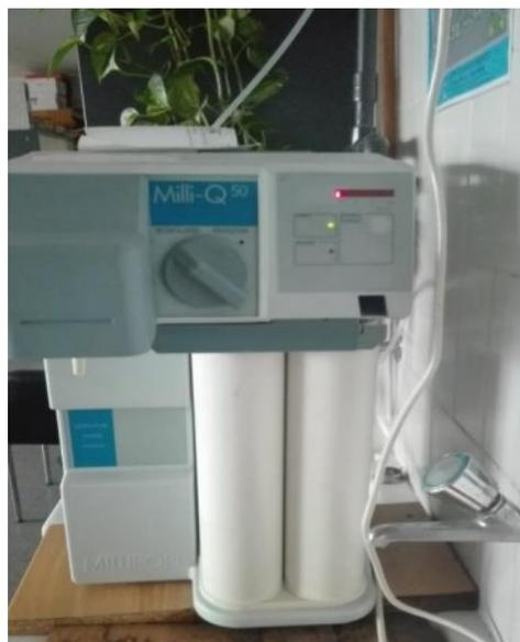
**Figura 15.-** Sistema de tratamiento de agua Milli-Q<sup>50</sup> situado en el laboratorio de Química Analítica de la Facultad de Farmacia
